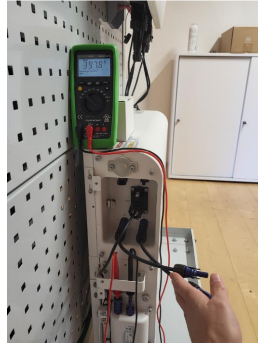
DC-Ausgangsspannung direkt am Modul messen
